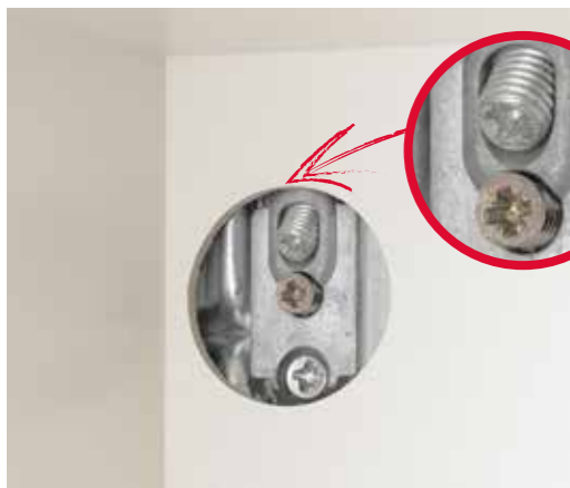
Aufhängebeschlag im Inneren des Schrankes mit Justierung und Aushängesicherung – nach erfolgter Wandmontage durch Abdeckkappe verborgen.
